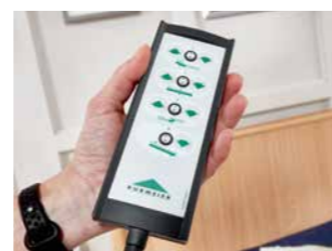
Handschalter mit selektiver Sperrung
