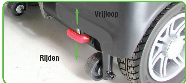
De vrijloophendel maakt het mogelijk de automatische rem los te koppelen, zodat de scootmobiel met de hand geduwd en/of gemanoeuvreerd kan worden. In vrijloop werken de remmen niet, daarom mag deze niet gebruikt worden wanneer:
